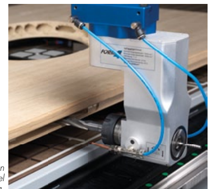
C-axeln står till förfogande som en fjärde interpolerande (360°) axel med tryckluftsanslutning.
